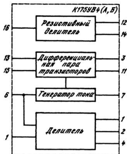
Рис. 2.115. Принципиальная электрическая схема ИМС К175УВ4 (А, Б)
