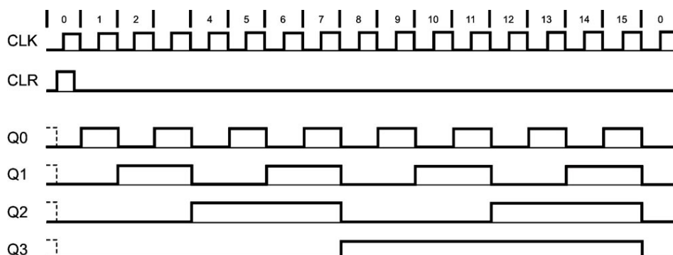
Рис. 2. Временная диаграмма микросхем 1564ИЕ19 ЭП.
