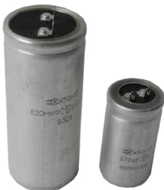
Конденсаторы предназначены для работы в импульсном режиме. Находят применение в лазерной технике, медтехнике, сварочном оборудовании. Частота следования импульсов не более 1/10 Гц. Минимальное количество импульсов – 100 000.
